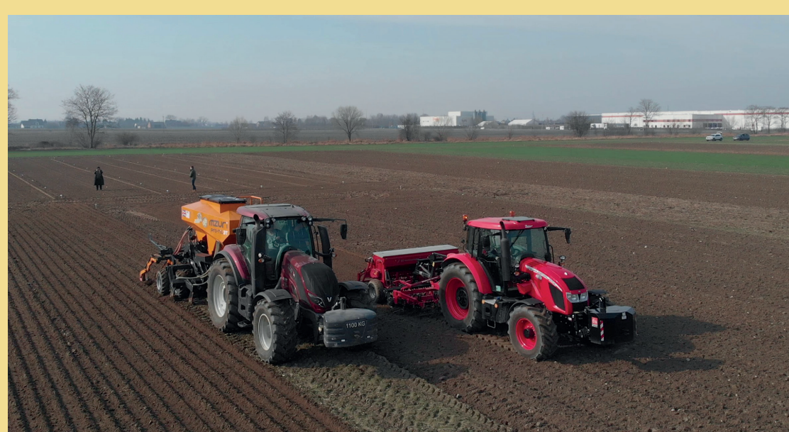
Ryc. 8. Widok siewu pasowego (ang. strip-till) z lewej oraz tradycyjnego siewu rzędowego. (Źródło: SGGW TV)
