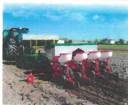
Agregat do jednoczesnej pasowej uprawy gleby, nawożenia i siewu
