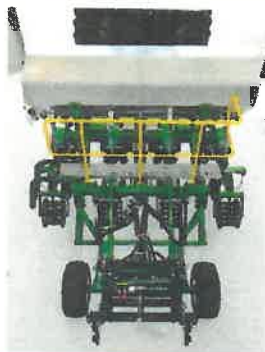
Moduł roboczy do jednoczesnej uprawy pasowej i głębszej aplikacji nawozu w postaci supergranul
