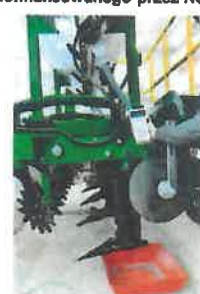
Ząb sekcji do uprawy gleby i wysiewu nawozów wg wynalazku PIMR, patentu PL nr 222931
