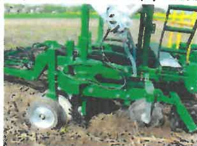
Sekcja robocza do pasowej uprawy gleby i wysiewu nawozów wg wynalazku PIMR, patentu PL nr 222932
